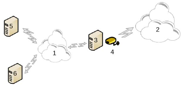
当您的计算机 (3) 同时连接到互联网 (2) 和 局域网 (1) 时,可以使用此工具。您可以将计算机 (3) 作为网关,以便为局域网 (1) 中的其他工作站 (5) 和 (6) 提供互联网访问。因此,作为网关的计算机必须有两个网络接口:一个可以是以太网卡,连接到局域网;另一个 (4) 连接到互联网 (2)。
